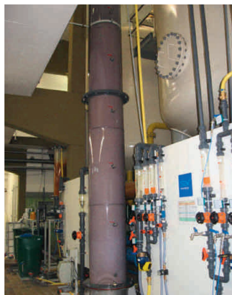
Abb. 2 Gross-Versuchsreaktor (d = 0,5 m) mit transparenten geflanschten Schüssen aus Plexiglas.
