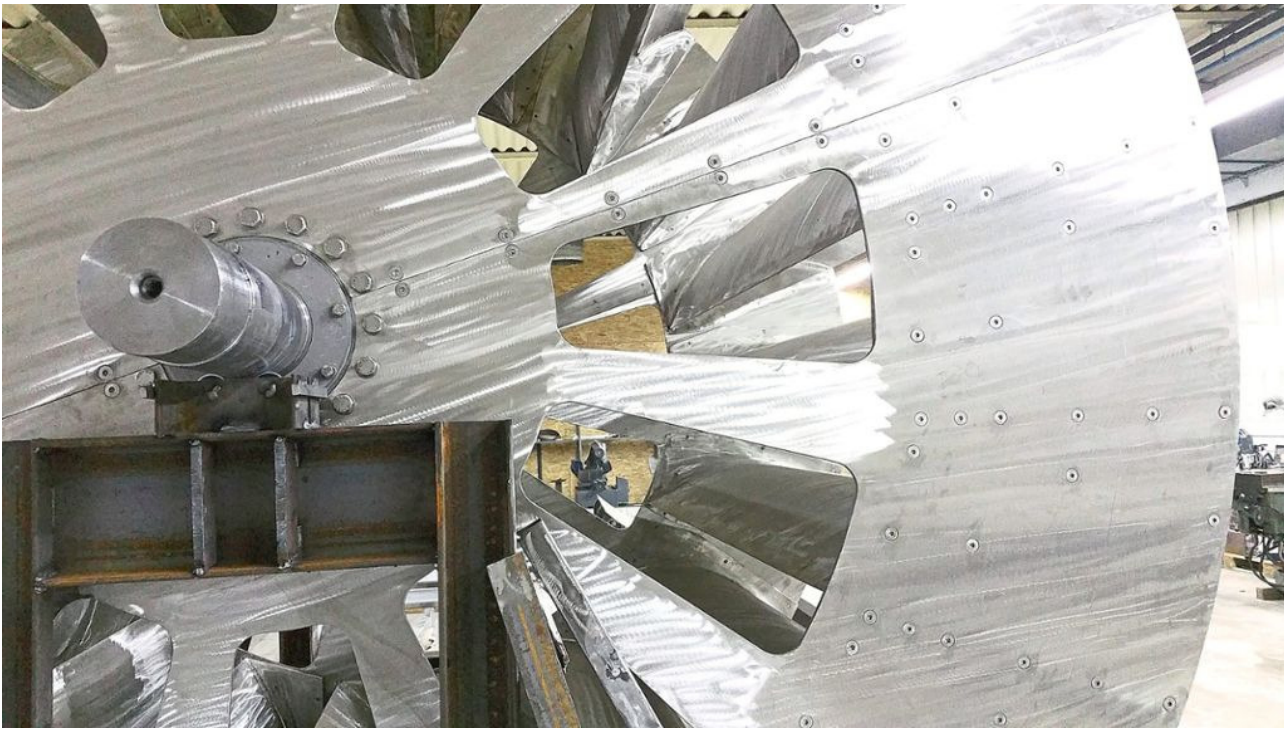
Eine Lamellenturbine wie diese soll in Horb künftig zum Einsatz kommen. Foto: Privat
